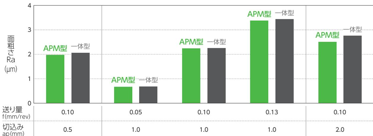
被削材: SUS420J2 使用工具 シャンク: APM-R1212X84J ヘッド: APM12-SDJCR11T3J インサート: DCGT11T302MN-SI (AC1030U)
